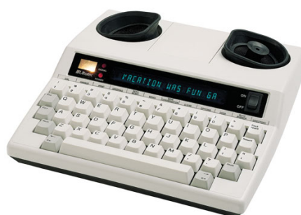
Figura 2. Dispositivo DTS. En la parte superior, dos bases para colocar el auricular del terminal fijo.
